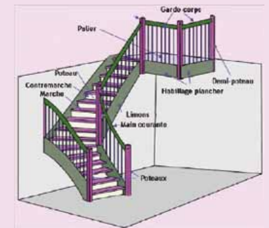
Structure d'un escalier
