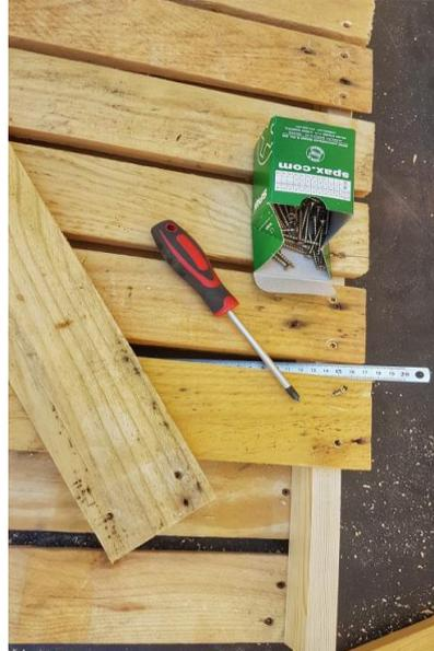
On continue ensuite avec l'un des flans du composteur. On recommence avec des planches régulièrement espacées de 10mm. Pour l'esthétique de la face avant, on peut faire les planches plus longues pour recouvrir l'épaisseur des planches latérales. On continue de la même manière pour le flan opposé:
